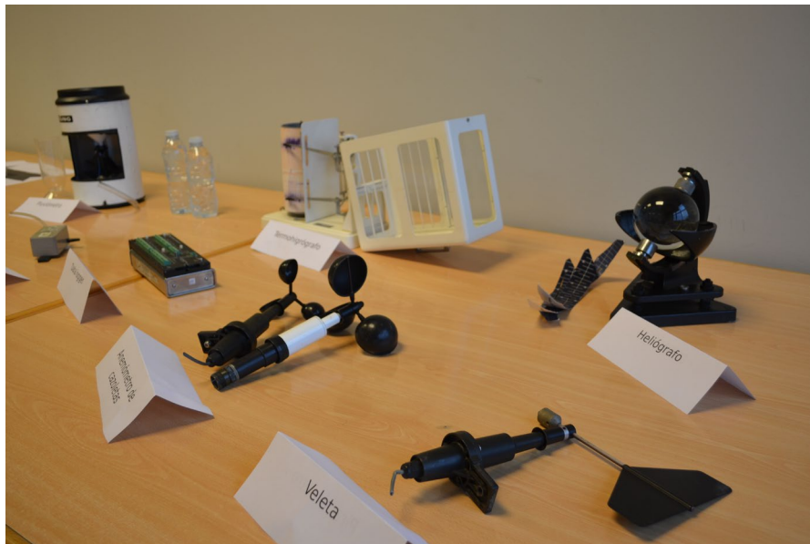
Figura 3. Exemplos de instrumentos meteorolóxicos traballados en clase.
